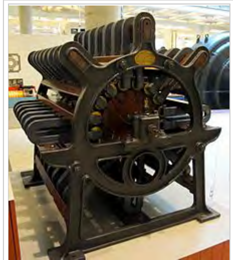
2kW Société de l'Alliance magneto generator for arc lamps, of around 1870
