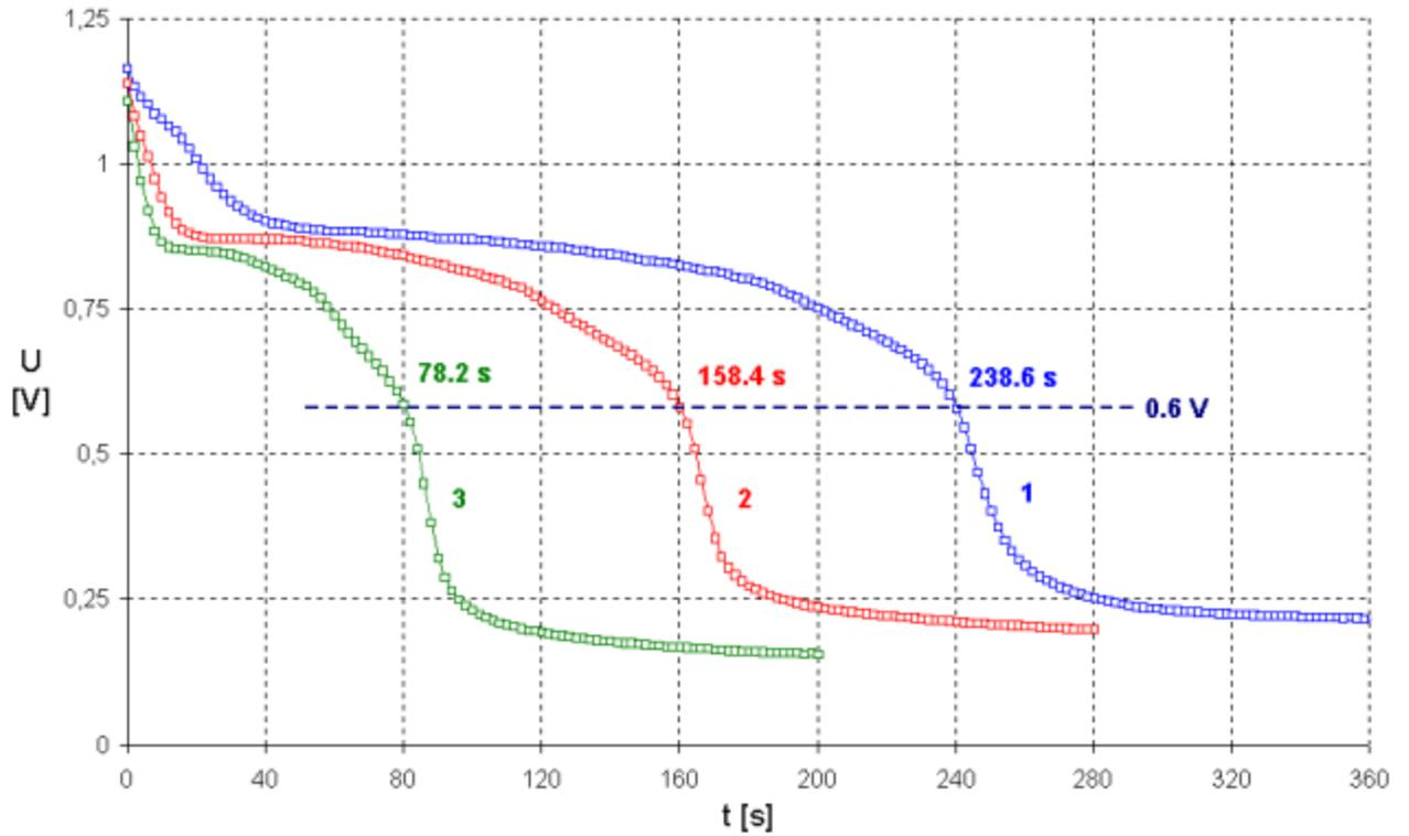
**Fig. 6: Discharging at 20 mA (1), 30 mA (2) und 40 mA (3)**
